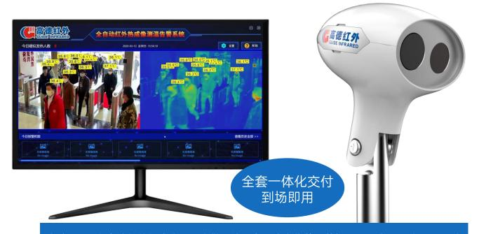
高德IR236全自动红外热成像测温告警系统可在人流密集的公共场所进行大面积监测,通过 系统非接触式对人员体温进行初筛,快速找出并追踪体温超温人员,帮助排查人体发热症状。 IR236结合了红外人体测温算法和AI智能人脸识别等先进技术,测温精准且操作简单方便。 该系统功能强大,多目标跟踪可确保不遗漏目标,自定义报警温区和高温屏蔽设置可避免其 它高温物体的干扰,发现超温人员自动报警并拍照存储,支持录像,方便用户查询与分类管 理,是政府机关、机场、车站、大型工厂、学校、商业中心等公共场所卫生防疫的理想设备。
