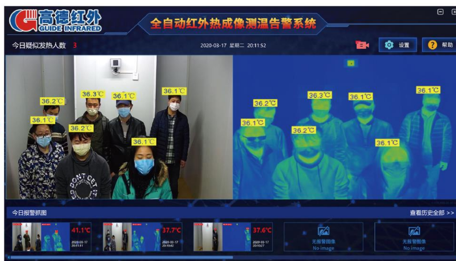
测温界面 (现场温度测试)
