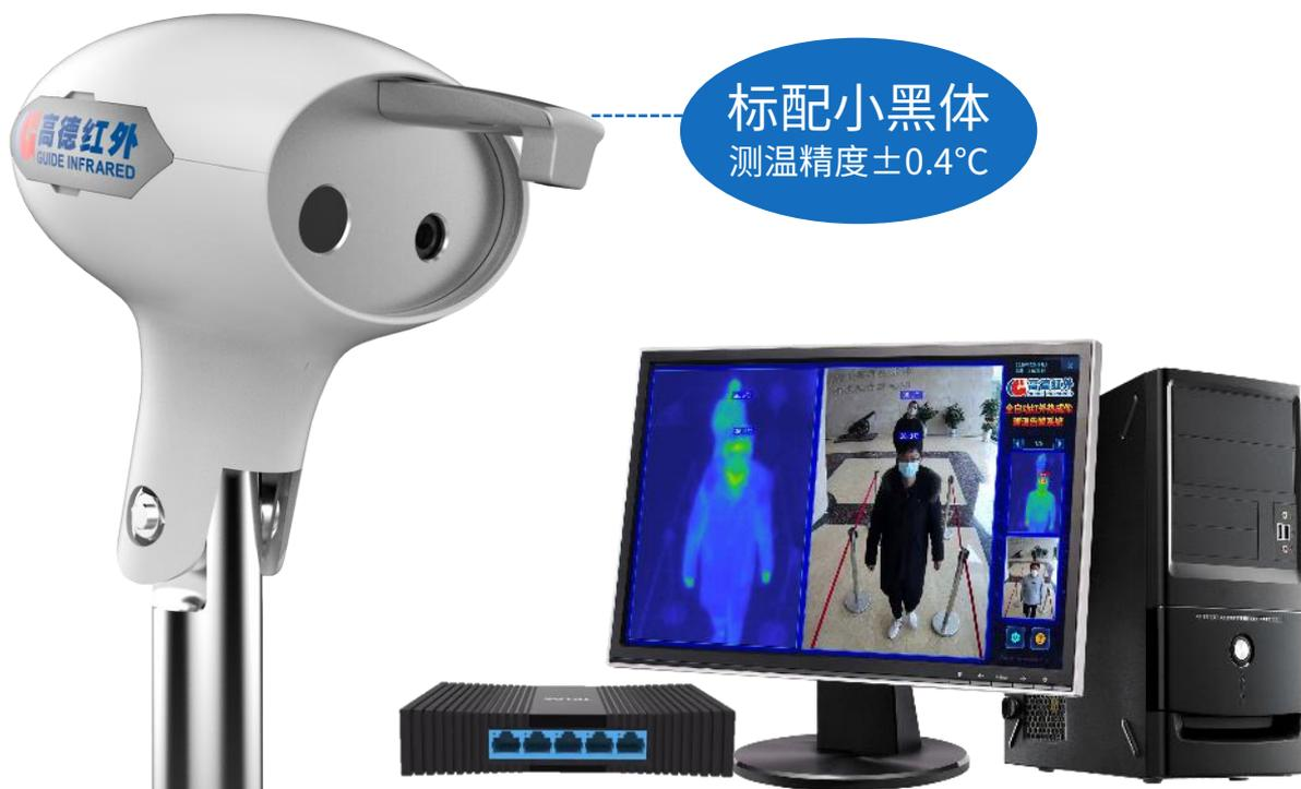
G120全自动红外热成像测温告警系统采用红外热成像技术，可在人流密集的公共场所进行快速体温筛查，一旦监测到体温超标的目标就会自动报警并拍照留存，可大面积排查人群中的发热人员，提高疫情防控效率，大大降低传染风险。
