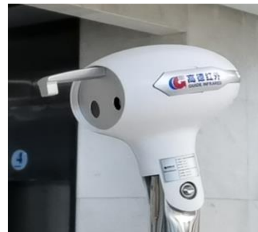
8. 把网线及电源线接到机头对应位置，调节机头到合适的角度（一般设置向下俯视角为13°-15°），并固定螺栓
