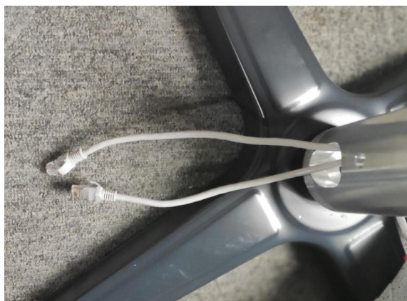
6.解开胶带，把二根网线从立杆底部的孔中往外抽，直到支杆顶部还余25厘米左右时停止（注：一定不要把电源延长线一起抽出）
