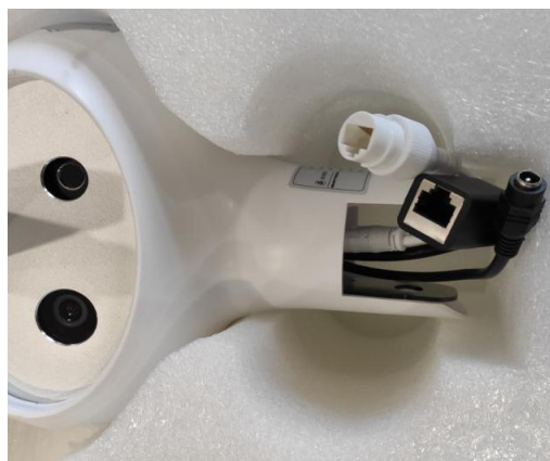
7. 将电源线、网线与机头接头相连接，并将立杆与机头用螺栓M4×10螺钉箍紧
