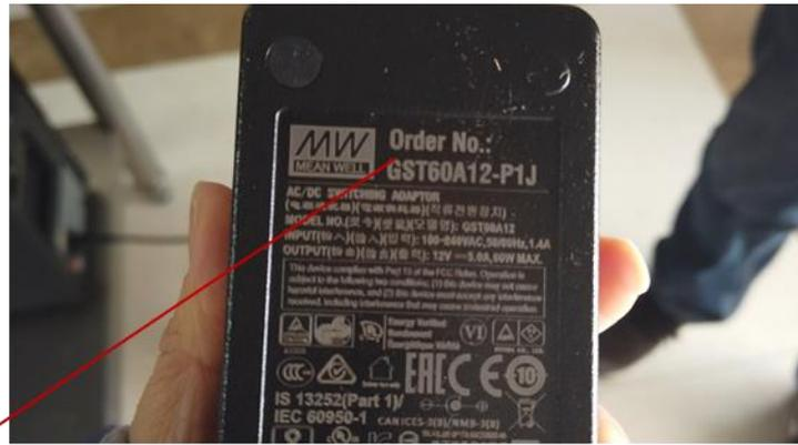
4. 机头电源AC-DC 适配器12V/5A
