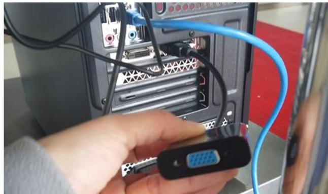
3. 电脑主机的独立显卡接口经转接线连接VGA线缆，电脑主机接入音响
