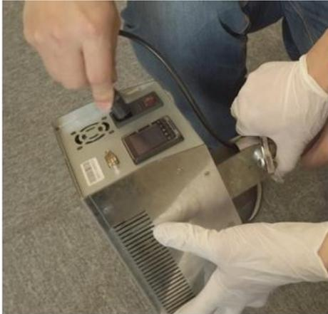
7. 接上黑体的电源线，调整到合适角度并固定螺栓
