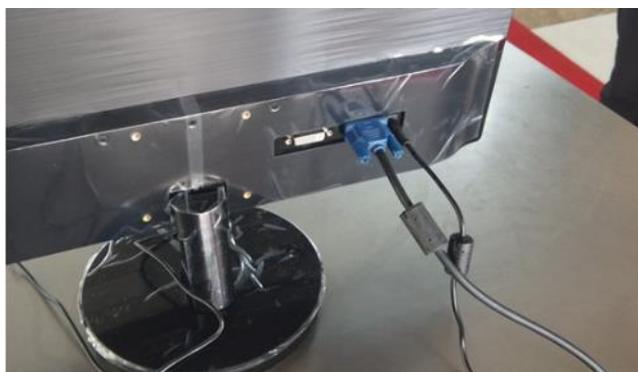
1.组装显示器，连接VGA线缆和直流供电线缆
