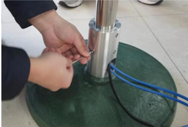
5.安装立杆和底盘转接件，用8颗M4×10螺钉紧固
