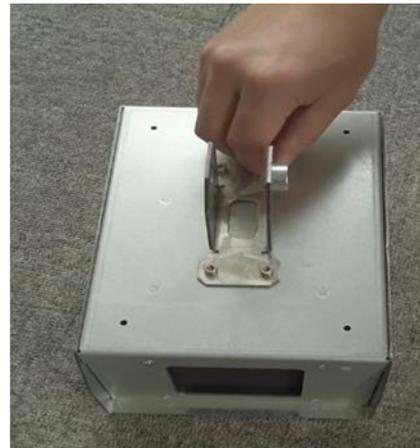
2.安装黑体和转接件，用4个M4×10螺钉紧固
