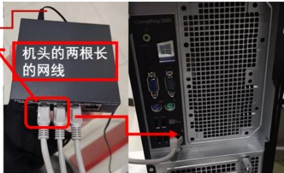
2. 机头两根长的网线接交换机，交换机用短网线和主机箱的网口相连。
